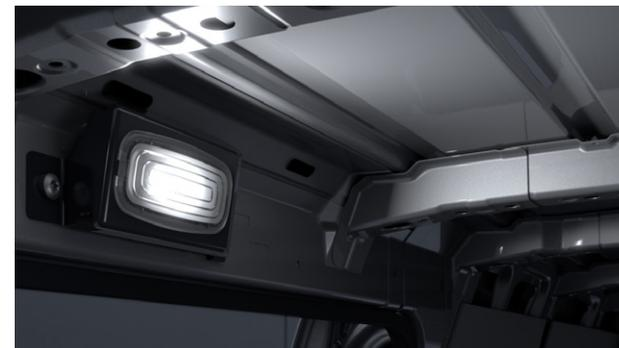
La iluminación con diodos luminiscentes en el espacio de carga se conecta automáticamente con un interruptor de contacto cuando se abren las puertas posteriores o correderas del vehículo.
