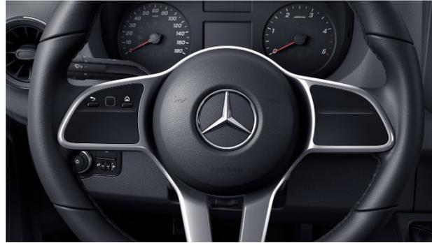
Utilizando los botones de control táctil o las teclas del volante multifunción puede usted manejar confortablemente el ordenador de a bordo y algunas funciones del vehículo.
