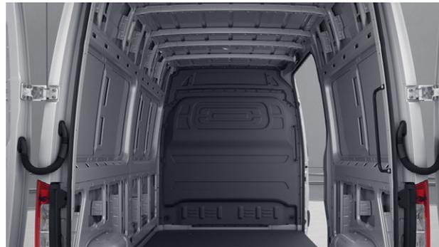
En la nueva Sprinter Cargo la pared divisoria protege al conductor y el acompañante de carga que pueda caer, así como la suciedad del espacio de carga, y mejora al mismo tiempo la insonorización y el aislamiento térmico delante en la cabina.
