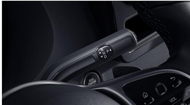
La opción de transmisión automática 7G-TRONIC PLUS de 7 velocidades mantiene el número de revoluciones del motor lo más bajo posible en todas las situaciones de conducción. Esto repercute positivamente en el consumo de combustible y mejora el confort acústico.
