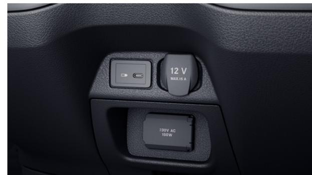
La conexión USB de 5 V ofrece una posibilidad adicional de carga junto a la caja de enchufe de 12 V de serie y permite cargar dispositivos eléctricos al alcance del conductor y del acompañante.
